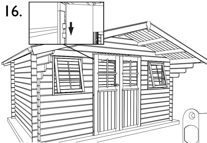
**NL:** Tot slot dient U enkel nog de afdeklatten boven raam en deur te plaatsen. Plaats binnen én buiten de sierlat SRD bovenop de kader van de deur. Zij dient om de opening bovenaan te verbergen tijdens het werken van het hout (cfr "hout leeft"). Zet vast met vijzen van 25 mm **op de kader**.
