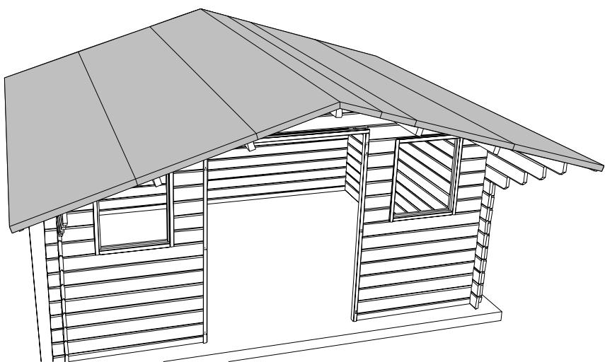
**NL:** Indien U een dakgotenset kocht , monteert U deze dan nu op de ZSL. Voor de modellen met shingles verwijzen we naar punt 13. Voor niet meegeleverde dakbedekkingen verwijzen we naar uw leverancier van de bedekkingen, hou er wel rekening mee dat de daken berekend zijn op een maximale belasting van 50kg/m<sup>2</sup>.
