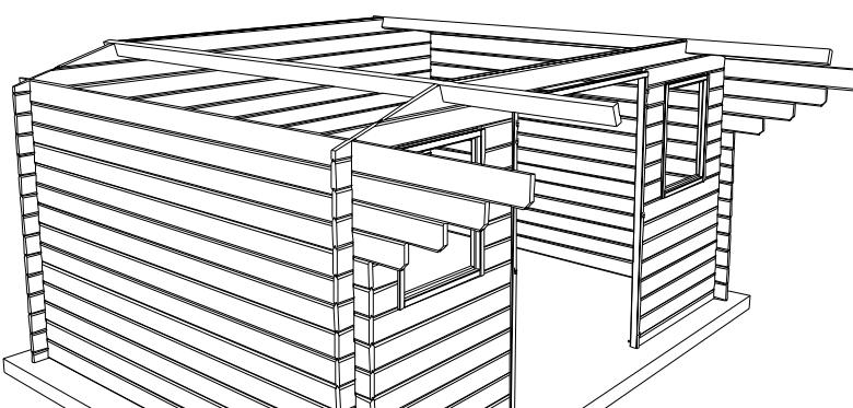
**NL:** Werk de puntgevels verder af. Herhaal hiervoor stappen 7 en 8 tot U aan de nokbalk komt, plaats ook deze. (Het aantal dakbalken van uw blokhut kan afwijken t.o.v. de tekening).
