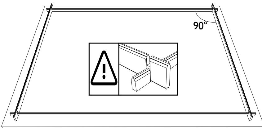
**NL:** Zorg ervoor dat U onmiddellijk  $90^\circ$  bekomt in uw hoekverbinding. De tand hoort bovenaan. De onderste plank in het voor- en achterpaneel is een halve lat met enkel een tand, de onderste plank van het zijpaneel heeft tand en groef. Zorg ervoor dat de planken mooi op de grond steunen.
